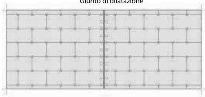
Collocazione di un giunto di dilatazione con posizione dei supporti (interasse 30 cm) - PER AMBIENTI OLTRE I 40M<sup>2</sup>
