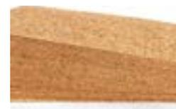
Pannello in sughero biondo densità 220 kg/m<sup>3</sup> | Conduttività termica dichiarata  $\lambda_b$ [W/(m\*k)] 0,052 | Calore specifico c 1.674 J/kg K
