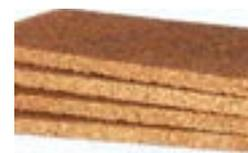
Pannello in sughero biondo densità 150÷160 kg/m<sup>3</sup> | Conduttività termica dichiarata  $\lambda_b$ [W/(m\*k)] 0,041 | Calore specifico c 1.674 J/kg K
