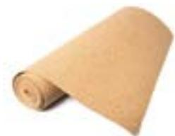
Rotolo in sughero biondo densità 150÷160 kg/m<sup>3</sup> | Conduttività termica dichiarata  $\lambda_b$ [W/(m\*k)] 0,041 | Calore specifico c 1.674 J/kg K
