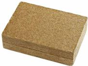
**FiberTherm 160** Fibra di Legno densità  $160 \text{ Kg/m}^3$ . Il pannello FiberTherm in fibra di legno è un isolante termo-acustico multi-uso, prodotto tramite processo a umido. Formato pannello  $1350 \times 600 \text{ mm}$ . Disponibile in spessori da 20 a 200 mm.
