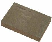
**BetonWood N** Il pannello BetonWood, ad alta densità (1350 Kg/m<sup>3</sup>), realizzato in conglomerato cementizio tipo Portland e fibra di legno di Pino scortecciato. Caratteristiche termodinamiche: coefficiente di conduttività termica  $\lambda=0,26$  W/mK, calore specifico  $c=1,88$  KJ/Kg K, coefficiente di resistenza alla penetrazione del vapore  $\mu=22,6$  e classe di reazione al fuoco A2-fl-s1, secondo la norma EN 13501-1.
