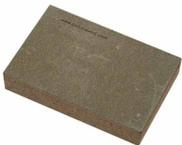
**BetonWood N** Il pannello BetonWood, ad alta densità (1350 Kg/m<sup>3</sup>), realizzato in conglomerato cementizio tipo Portland e fibra di legno di Pino scortecciato. Caratteristiche termodinamiche: coefficiente di conduttività termica  $\lambda=0,26$  W/mK, calore specifico  $c=1,88$  KJ/Kg K, coefficiente di resistenza alla penetrazione del vapore  $\mu=22,6$  e classe di reazione al fuoco A2-fl-s1, secondo la norma EN 13501-1.
